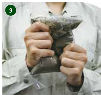
③ 袋ごとよく振って攪拌し 全体が均一な硬さになるまで 揉み込むように混ぜ合わせます。
