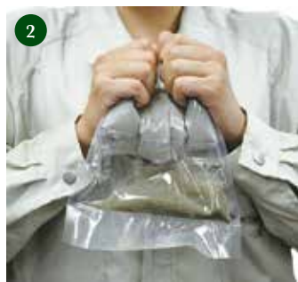
② 粉体部を強く握って 粉体を水溶液に押し出します。
