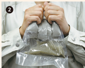
2 セメント部を強く握ってセメントを水溶液に押し出します。
